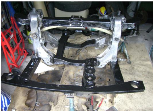
Weiter gings, um ein wirklich dauerhaftes Ergebnis zu erreichen, wollte ich auch alle (!) Fahrwerksbuchsen ersetzen. Nicht das man dann, kaum ist alles zusammengebaut, wieder an Teile heran muss, an welche man eh kaum dran kommt. Das mit den Fahrwerksbuchsen ist so eine Sache gewesen.
