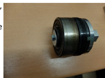
Bild 10: Nutmutter für Radlageraußenring Vorderachse
